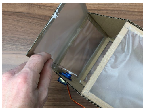
Obr. 15 – Připevnění sponky k servu
