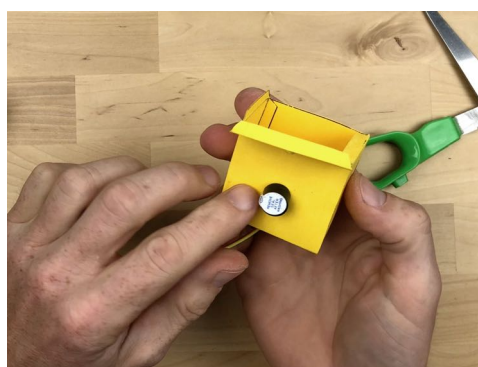
Obr. 15 – Připevnění bzučáku vodiči
