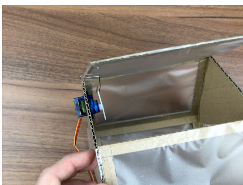
Obr. 16 – Spojení serva se střechou
