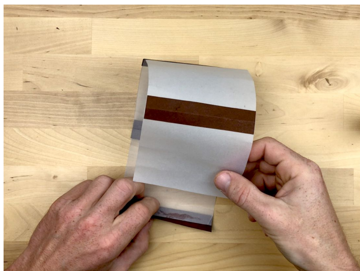
Obr. 11 - Lepení bočních stěn
