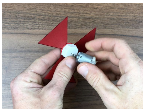
Obr. 11 – Nasazení vrtule na motor
