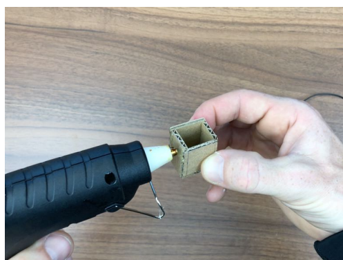
Obr. 19 – Slepění pouzdra na motor
